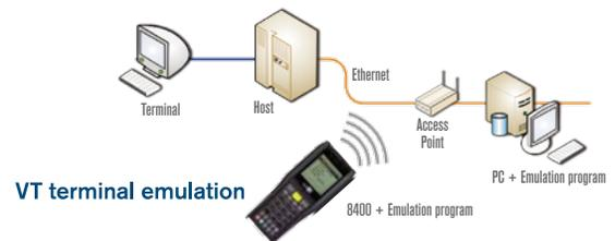
Der 8400er emuliert Terminals VT100, VT220 und TN5250. Ein großes, helles Display, funktionsgerechte alphanumerische Tastatur und verlängerte Akkulaufzeit gewährleisten, dass die Kraft der Terminalemulation jederzeit zur Verfügung steht.
