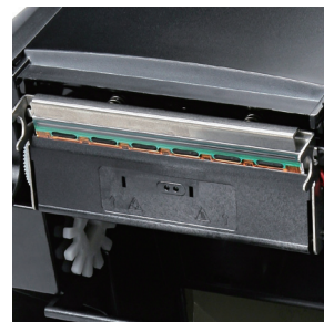
"Twin-Sensor"-Technologie erlaubt den Einsatz unterschiedlichster Etiketten
