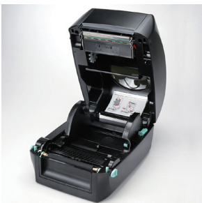
Einfach aufklappen und Etiketten einlegen – fertig
